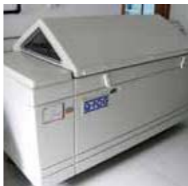
Test de vieillissement UV au xénon pour Syntek® et PMMA Xenon arc weathering for Syntek® and PMMA Prueba de envejecimiento al xenón para Syntek® y PMMA
