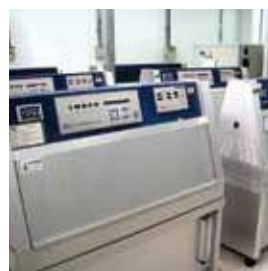
Test de brouillard salin pour structures aluminium et inox Neutral salt spray for stainless and steel aluminium structures Prueba de niebla salina para estructuras en aluminio y acero inoxidable
